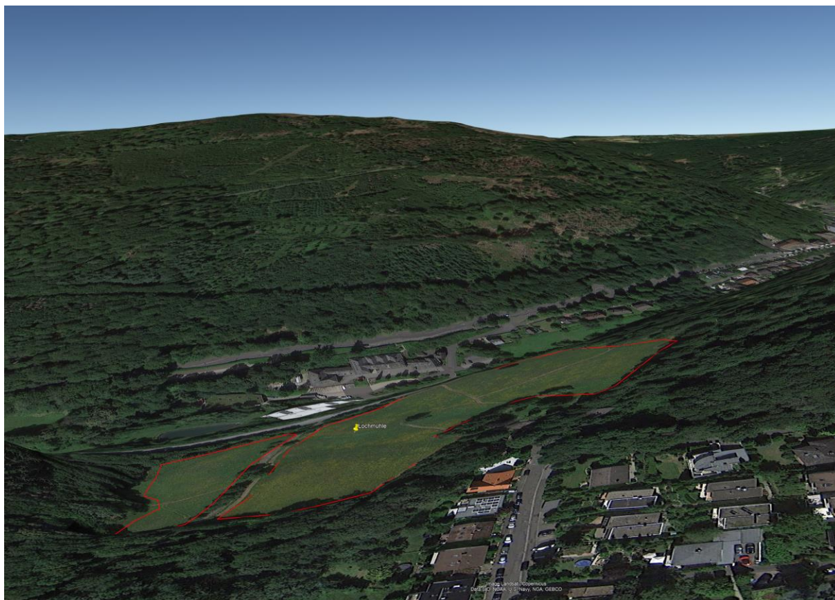
Abbildung 8: Der Berg westlich der PVA wurde als Verschattungsquelle in der Simulation berücksichtigt - Quelle Abbildung: Google Earth Pro
