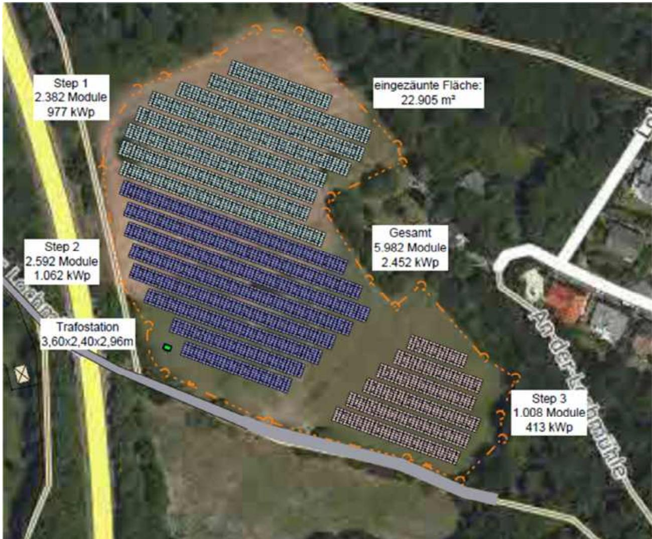
Abb. 3: Ausschnitt aus dem Modulbelegungsplan [3]
