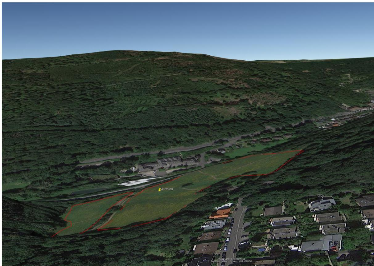
*Abbildung 8: Der Berg westlich der PVA wurde als Verschattungsquelle in der Simulation berücksichtigt
